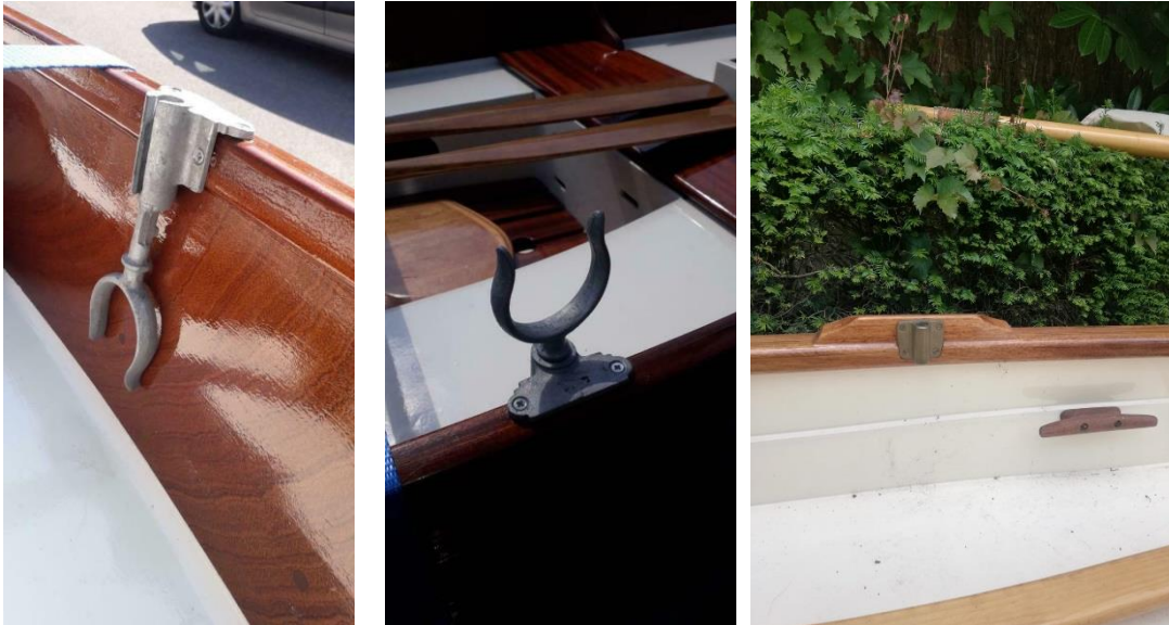
Enkele verschillende typen roeidoft en roeidol en dolpot
